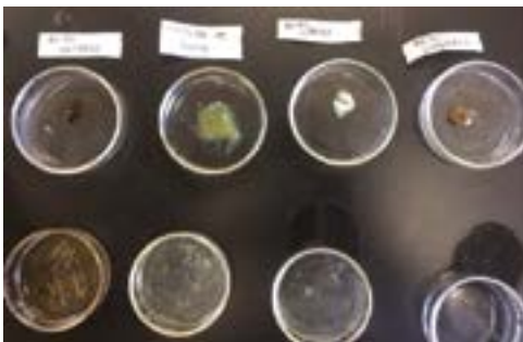
Figura 6. Prueba de resistencia a la acidez y la alcalinidad
