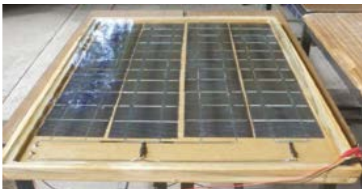
Imagen 2. Panel solar que proporciona una tensión de 11 V y corriente de 7.2 A./Pável Castillo
