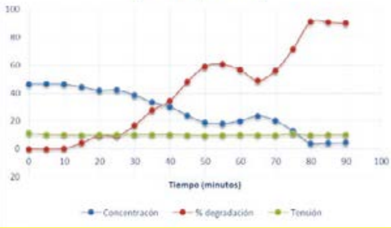
Gráfica 6. Cinética de degradación de rojo congo al utilizar 2 por ciento de peróxido de hidrógeno
