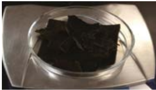
Figura 5. Biopolímero con cáscara de mango
