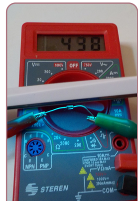
▼ Fig. 6. Diferencia de potencial en el diodo con una fuente UVC.
