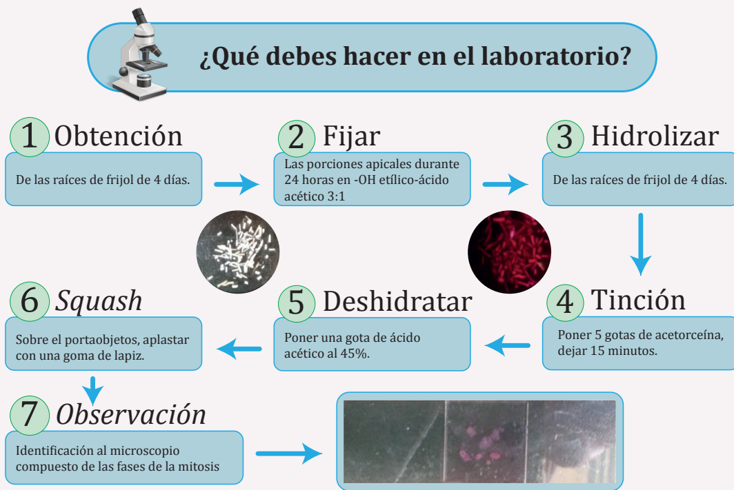
▼ Figura 4. Diagrama de flujo simplificado del procedimiento.
