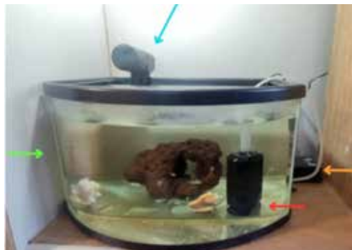
▼ Figura 2. Fotografía de la pecera de experimentación y sus componentes, instalada en el Acuario CCH Sur. La flecha verde indica la pecera de 40 L, la flecha azul indica el alimentador automático, la flecha naranja indica la bomba de oxígeno y la flecha roja indica el filtro.
