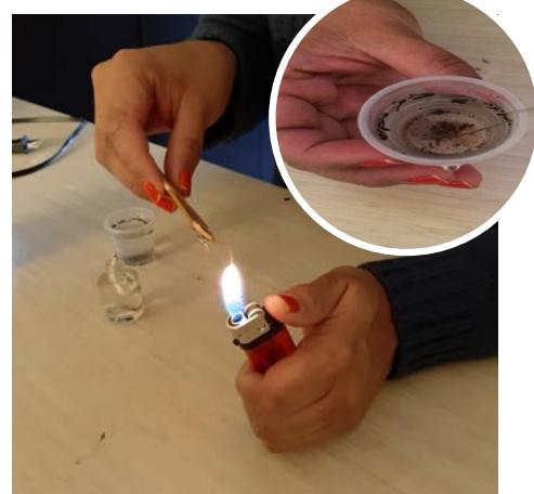
**Imagen 2.** Se ilustra la toma de muestras e identificación de iones a la flama.
