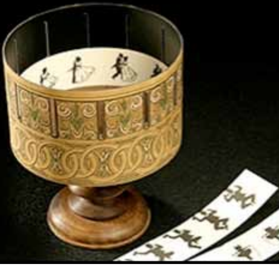
Zoótrofo, de los étimos griegos ζωός (zoós), adjetivo que significa "vivo" y τροπή (tropé), máquina creada en 1834 por William George Horner; los dibujos dispuestos en tiras sobre el tambor, al girar, den la ilusión de animación.
