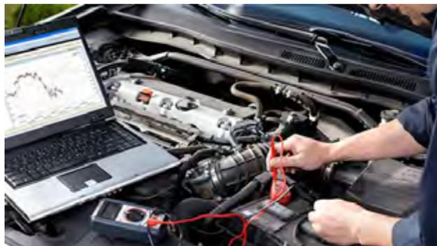
OBD significa *On Board Diagnostic* (diagnóstico a bordo) y evolucionó al OBD1 y al actual OBD2. Al ser universal, se pueden tener distintas marcas de productores de escáneres para diagnosticar el estado del motor y la caja de velocidades automática entre los datos más importantes, pero también hay escáneres de bajo precio (menos de 300 pesos)
